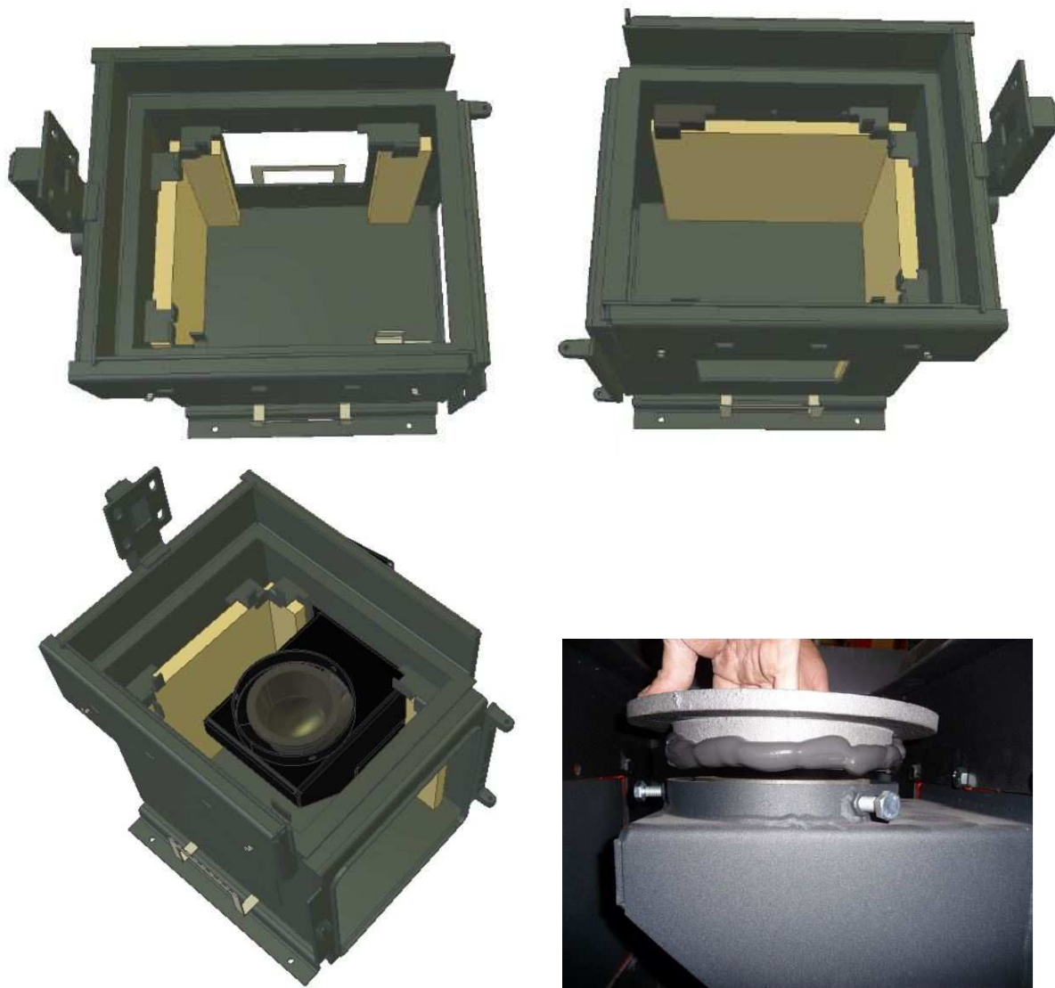
Obr. č. 7 – instalace hořáku do podstavce
