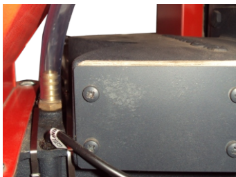
Rys. 6. Wąż ze złączką wkręcony do mufki w podajniku
