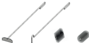
Rys. 8 - Akcesoria do konserwacji i czyszczenia kotła. Od lewej: zgarniak prosty, pogrzebacz, wycior ze szczotką do płomieniówek, szczotka okrągła.
